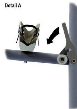
Der Schienenträger des Euro-Carry kann im unbeladenem Zustand hochgeklappt werden. Hierbei muss der Schienenträger aber mit dem im Lieferumfang befindlichen extra Zurrriemen am Grundträger gesichert werden. Zusätzlich können die Haltkrallen runtergeklappt werden.
