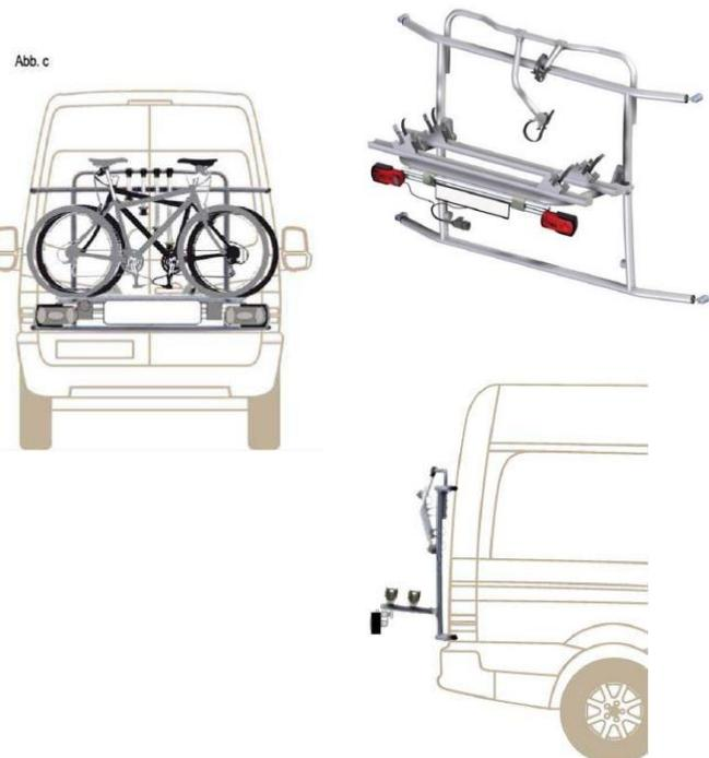
Heckscheibenwischers. Die Fahrräder werden grundsätzlich immer wechselseitig auf dem Träger angeordnet. (Abb. c)
