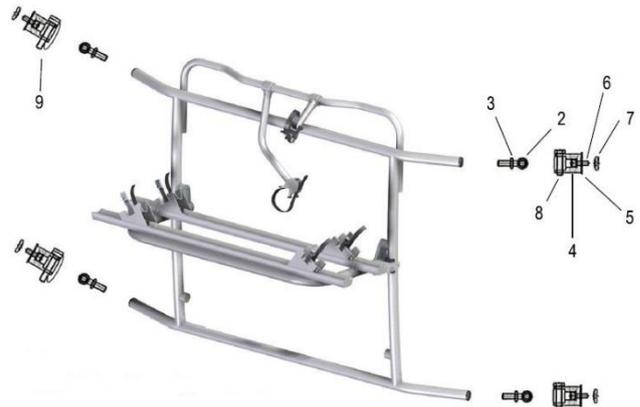
Nachdem Sie den Fahrradträger auf der Beifahrerseite mit dem Fahrzeug fest verschraubt haben, klappen Sie diesen an die Fahrzeugrückwand. Jetzt können Sie mit Hilfe der Ringschrauben den gewünschten Abstand zu den Scharnieren auf der Fahrerseite einstellen und diese Seite mit den 2 Sicherungssplinten (9) sichern.
