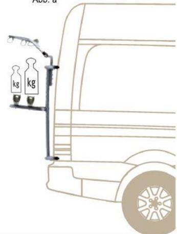
Die Arretierung muss im beladenen Zustand des Trägers vor der Abfahrt unbedingt eingerastet werden (Abb. Detail A)! Für Beschädigungen, die aufgrund eines nicht arretierten Auslegers resultieren, übernehmen wir keinerlei Haftung!
