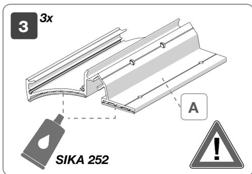
**ES** **Importante:** es fundamental usar el adhesivo SIKA 252 para fijar el soporte (los soportes).
