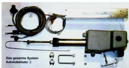
Die Bremsenheit 1 mit den zwei Bügelschrauben am vorderen Chassis anbringen und so positionieren, dass das Seil in einem möglichst spitzen Winkel auf das Bremsgestänge trifft.
