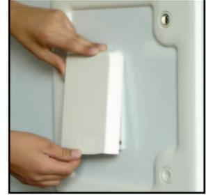
Abdeckung oben aufsetzen, unten etwas nach vorne ziehen. Abdeckung von oben nach unten schieben und einrasten. Beim Andrücken dieser, Schrauben einsetzen und leicht anziehen.
