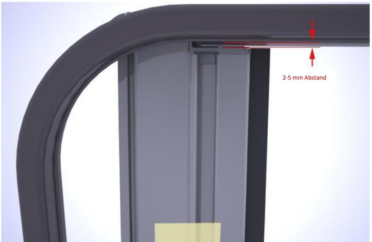
13) Nach der Montage des Gehäuse- und Zugstangenbausatzes überprüfen Sie bitte den Abstand zwischen Zugstange und Oberprofil. Der Abstand sollte innerhalb von 2-5mm liegen.
