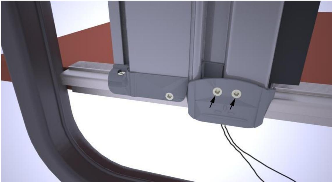
12) Befestigen Sie die Schiebeklemme mit 2 Stück 2,9x9mm Senkkopfschrauben am Schieber. Bei Verwendung von Elektrowerkzeugen zur Montage der kleineren Schrauben ist Vorsicht geboten, da sonst die Schraublöcher beschädigt werden könnten.
